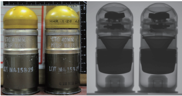
圖2 國內查獲的40公釐高爆穿甲雙效榴彈之外觀(左)和X光攝影(右)。
